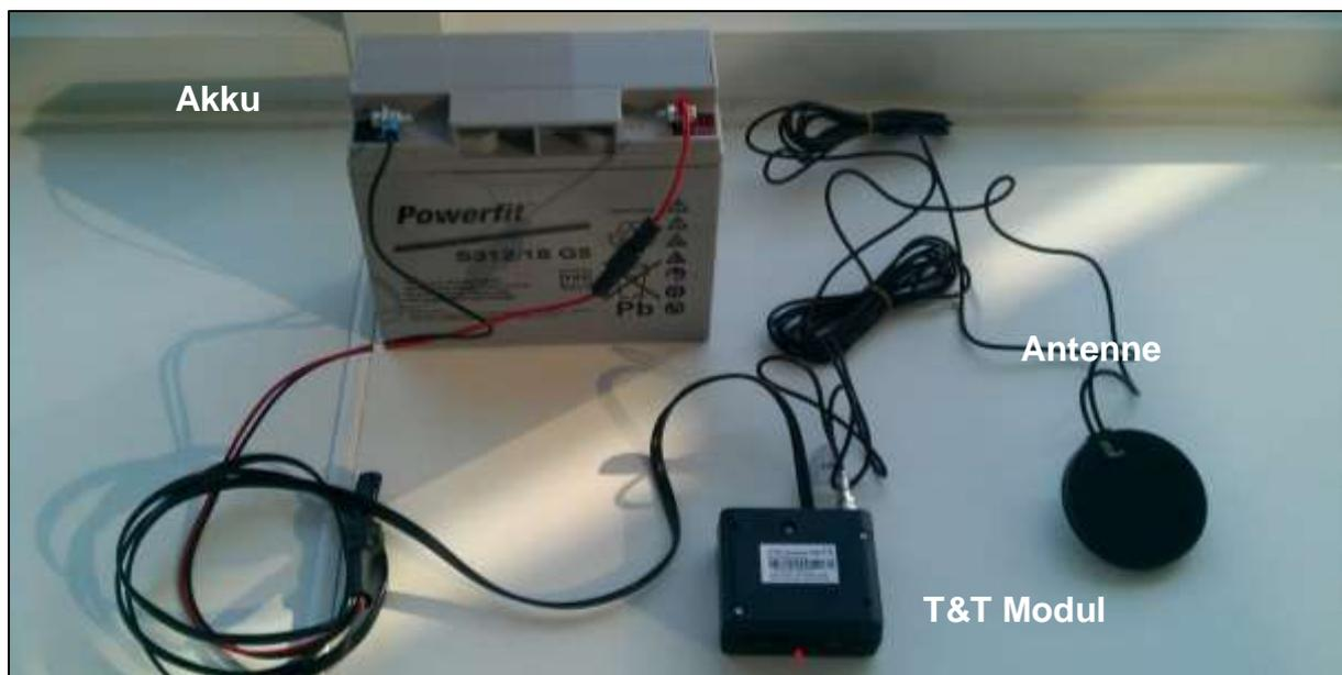
**Abbildung 3: Bestandteile der mobilen Sendungseinheit**
