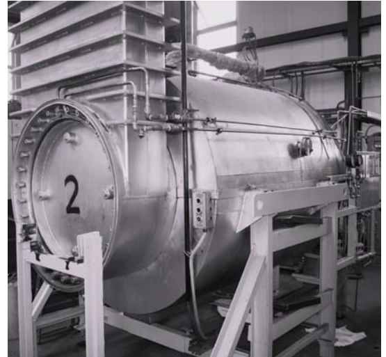
Abbildung 3: Kammerofen mit Stahlretorte
