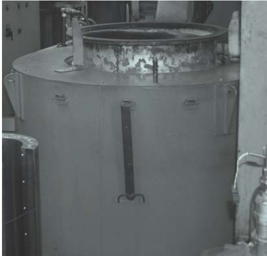
Abbildung 2: Schachtofen mit Stahlretorte
