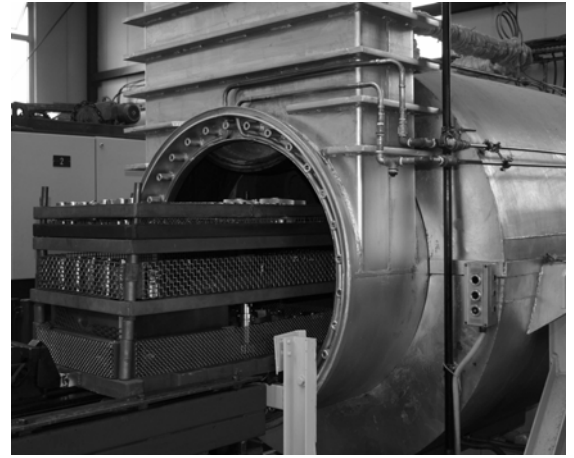
Abbildung 5: Beladung eines Kammerofens mit Stahlretorte
