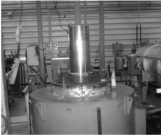
Abbildung 4: Beladung eines Schachtofens mit Stahlretorte
